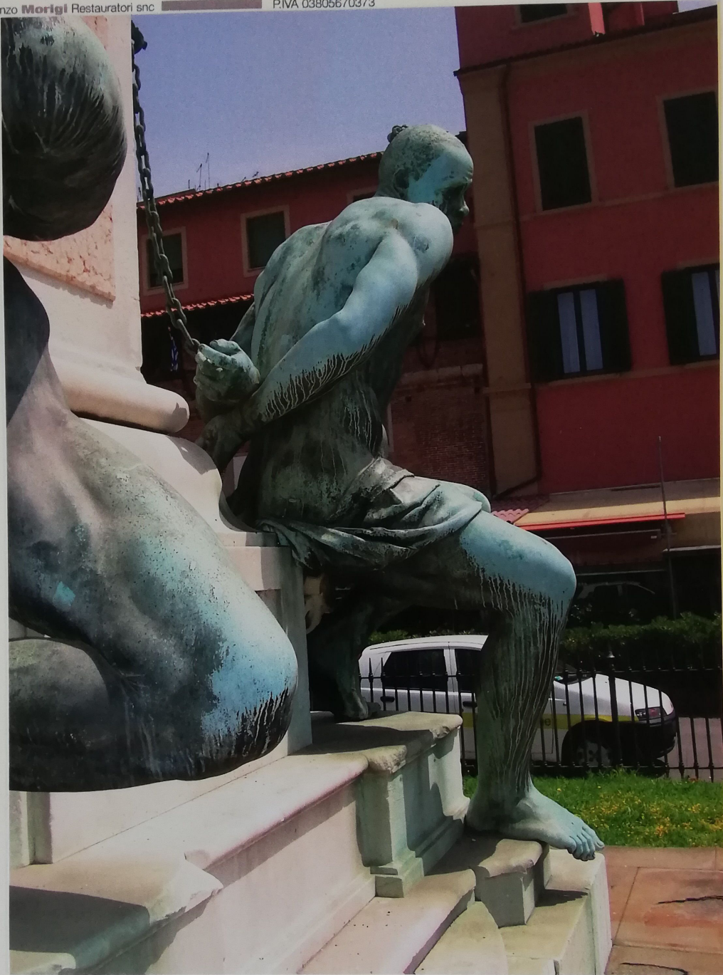
Foto 1. Moro di Sud Est. Si notano le ampie aree verdi sulle parti rivolte verso l'alto. Solitamente queste patine sono fortemente dilavate e sono composte da solfati più o meno solubili.
