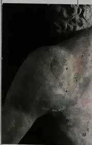
Nettuno ha spessori notevolmente variabili ed è costellata sia da bolle d'aria che da cricche passanti, anche di notevole lunghezza (fig. 1). La coda del delfino, fusa separatamente, è staccata a causa di una saldatura mal eseguita (fig. 2) e sulla sommità del capo una vistosa ammaccatura è attraversata da una lunga cricca passante (fig. 3).
