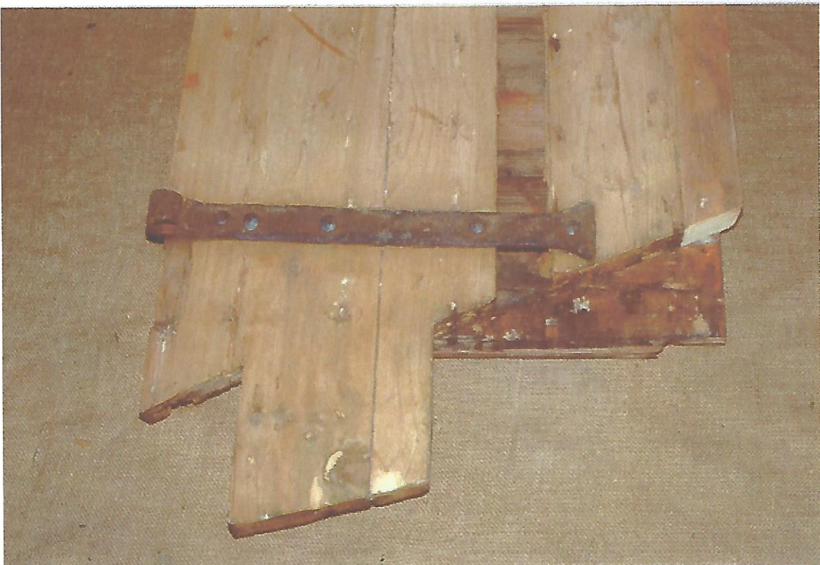
Idem, eliminazione delle integrazioni del restauro precedente e nuovi tagli
