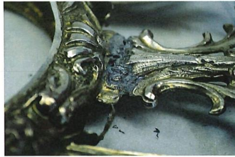
Illustrazione 2: Particolare di una saldatura a stagno sul decoro apicale della mostra
