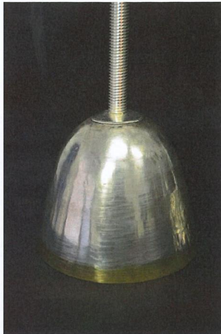
Illustrazione 3: Calice 1: incollaggio dell'estremità superiore alla coppa
